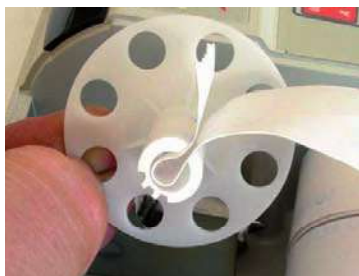
Rys. 2-2. Prawidłowy sposób zakładania taśmy papierowej na rolce zwiadcza
